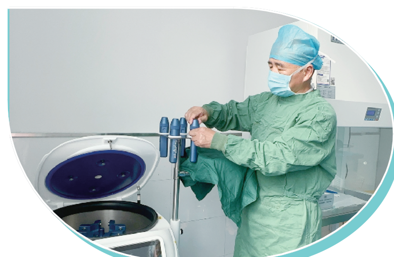
郸城县妇幼保健院可离心出高浓度富血小板血浆的离心机。
