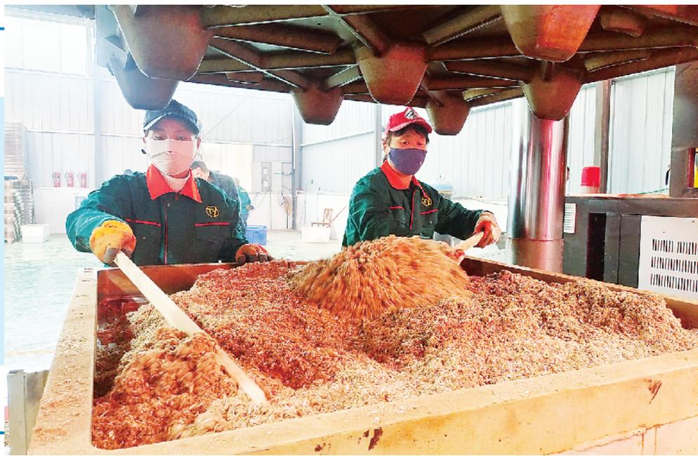
近年来,我市加大秸秆离田力度,通过制成肥料、饲料、饵料、基料和燃料,从源头减少田间秸秆存留,破解秸秆焚烧难题。图为近日,在周口市天佑绿托制造有限公司生产车间,工人以秸秆为原料生产物流托盘。记者 金月全 摄
